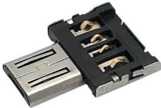
Diese funktionieren zwar, aber!! Man kann diesen auch um 180 ° gedreht in den Stecker des QCCP einführen und erzeugt dadurch einen absoluten **Kurzschluß!!!**
