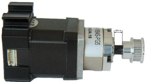
Das GT2 Zahnrad wird auf der Welle des Motors befestigt. Der Abstand zwischen Zahnrad und Motor sollte ca. 10mm betragen.
