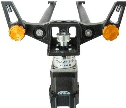
Der Motor wird von unten in die Öffnung der Motorplatte geschoben und mit 4 M3 Schrauben an der Motorplatte befestigt.
