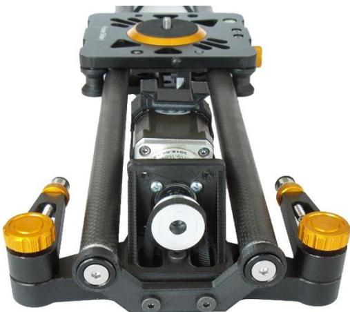
Dann wird das Seitenteil mit dem Motor nach links zwischen die Karbonstangen gekippt. Die Transport-Halterung wird mit den Schrauben an die Karbonstangen geschraubt.
