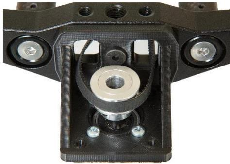
Der Riemen wird um das Zahnrad gelegt und durch die Öffnungen im Seitenteil geschoben. Dabei sollte eine Seite des Riemens bis zur Mitte des Sliders reichen. Die lange Seite des Riemens reicht damit bis zum anderen Ende und weiter.
