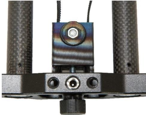
Das Gehäuse mit dem eingelegten Riemen wird dann mit den Nasen in die Öffnungen des hinteren Seitenteils geschoben und mit der Sternkopfschraube in der 1/4 Zoll Bohrung befestigt. Dabei die Sternkopfschraube nur leicht eindrehen.
