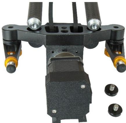
Das Seitenteil mit dem Motor wird von den Karbonstangen entfernt und nach rechts gekippt, sodass das Seitenteil unter den Karbonstangen liegt.
