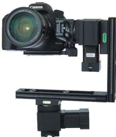
Um mehr Bewegungsspielraum für die Tilt Bewegung zu erhalten, kann eine L-Schiene (z.B. MENGS BPL-01AL) auf dem Frame PTH für Pan die Bewegung montiert werden. An dem senkrechten Teil der Schiene wird dann der Tilt PTH befestigt und letztendlich die Kamera daran. Mit dieser Montage kann auch eine Kamera mit großem Objektiv einfach auf den **Nodal-Punkt** ausgerichtet werden.
