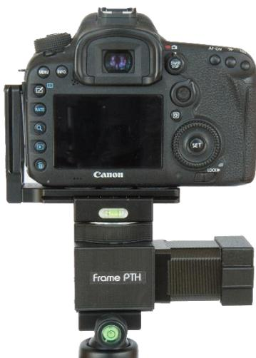
Zur Aufnahme eines Panoramas wird der **frame PTH** auf der Klemme des auf einem Stativ befestigten Kugelkopfes montiert und die Kamera dann an der Klemme des **frame PTH** befestigt.
