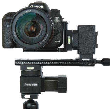
Für Gigapixel Aufnahmen werden 2 **frame PTH** benötigt. Zur Montage des 2. Frame PTH wird zunächst eine Arca-Swiss kompatible Schiene auf dem 1. **frame PTH** montiert, wie z.B. die MENGS FNR-200 welche an einem Ende eine Klemme zur Aufnahme des 2. **frame PTH** hat. Der Winkel für die Tilt Bewegung ist bei dieser Montage etwas eingeschränkt.
