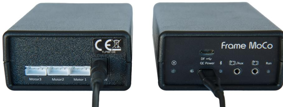
Abbildung 4: Stromversorgung: Links DC, rechts USB-C
