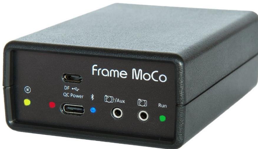
Die Intension zur Entwicklung des Frame MoCo war es, eine kostengünstige Alternative zu teuren Motion Controller Systemen zu bieten. Der Frame MoCo kann bis zu 3 Stepper Motore individuell steuern und ist somit für Anwendungen wie Motion Timelapse, Panorama Aufnahmen, Gigapixel, 360° und weitere Anwendungen bestens präpariert.
