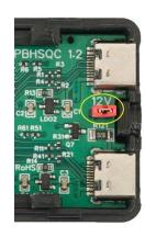
Um zu signalisieren, dass der PB HS QC auf 12V eingestellt ist blinkt die LED nach erfolgreicher Verbindung mit der PB im Rhythmus von 5 Sekunden.
